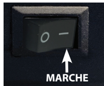
Figure 1 Interrupteur de la batterie Arrêt = « O » et Marche = « I »
